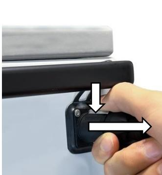
Zum Ausstecken ziehen Sie den Verriegelungsschieber zurück und drehen den Stecker gegen den Uhrzeigersinn. Sobald der Stecker aus der Arretierung gelöst ist, kann das Kabel aus der Buchse gezogen werden.
