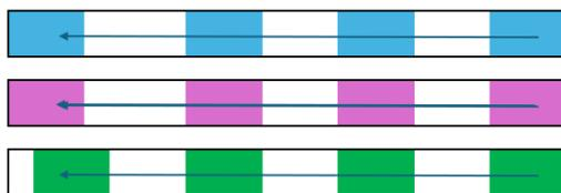
Bei zu **hoher Dichte** wechselt die Farbe über lila nach blau. Der Farbverlauf ist mit 1% - 5% Abweichung definiert.
