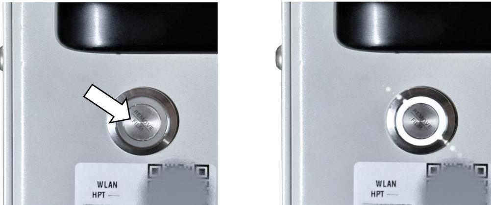
Nach dem Einschalten des Geräts leuchtet der LED-Balken und zeigt den aktuellen Ladezustand an. Das Gerät ist zu diesem Zeitpunkt noch nicht betriebsbereit. Hinweise zum Ladezustand finden Sie im entsprechenden Kapitel LED-Leuchtbalken.
