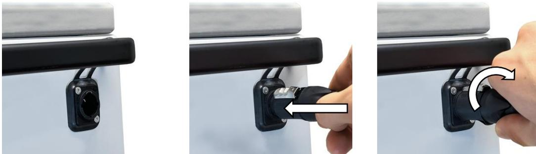
Das Anschließen des Netzkabels erfolgt durch das korrekte Ausrichten und Einsetzen des Steckers. Drehen Sie den Stecker anschließend im Uhrzeigersinn, bis ein Einrasten hörbar ist. Dadurch ist der Stecker vor unbeabsichtigtem Ausstecken geschützt.
